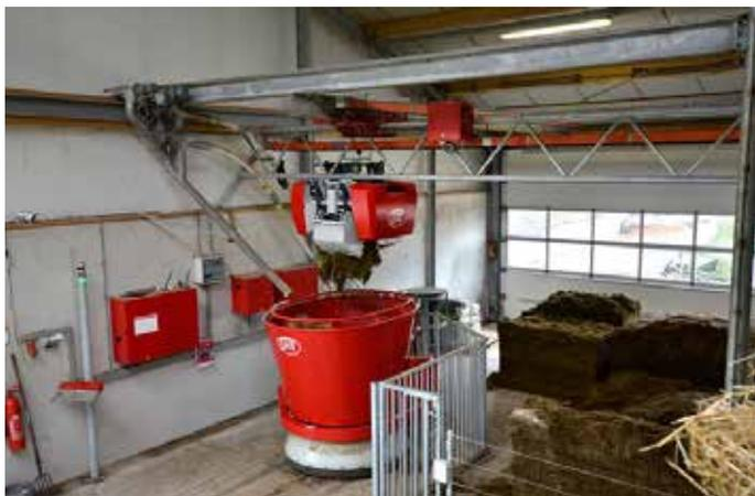
Grâce au système de grue, il est possible de placer autant de types de fourrage que souhaité dans la cuisine d'alimentation du Lely Vector et de les distribuer au troupeau.
