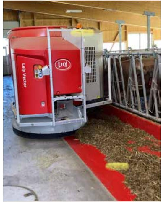
Le Vector pousse le fourrage et mesure la hauteur du fourrage.
